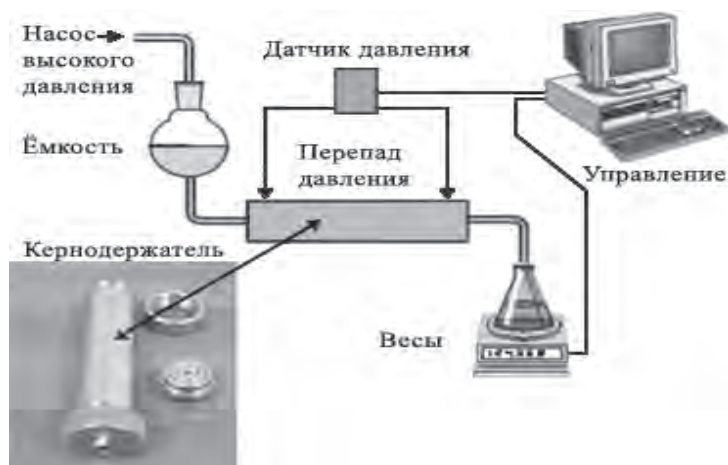
Рис. 1. Принципиальная схема насыпной песчаной модели
