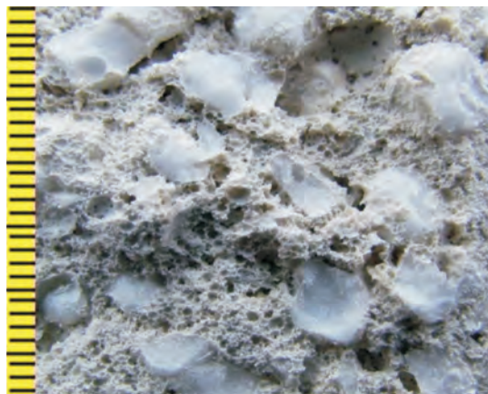
Рисунок 6 – Структура композита комплексной поризации
