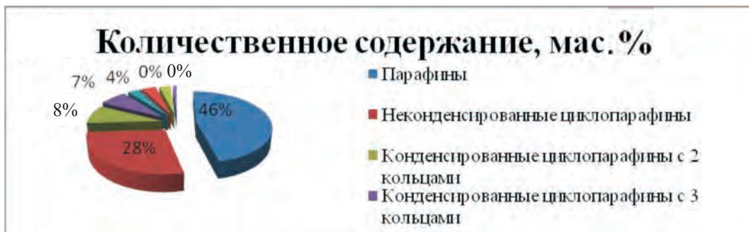
Рисунок 2 – Диаграмма группового состава углеводородов по результатам хроматомасс-спектрометрического анализа нефтешлама
