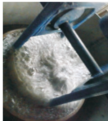
Рисунок 3 – Количество образующихся при работе флотационной машины пузырьков и выход в пенный продукт микросфер: а – с применением стандартного аэратора; б – с измененным аэратором
