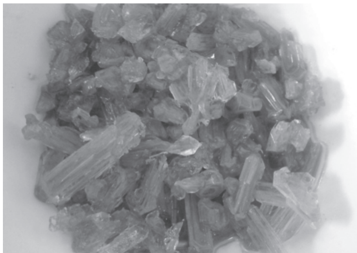
Рисунок 1 – Кристаллы ортофосфата натрия, полученного в процессе щелочного вскрытия ТМО
