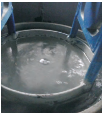
Рисунок 3 – Количество образующихся при работе флотационной машины пузырьков и выход в пенный продукт микросфер: а – с применением стандартного аэратора; б – с измененным аэратором
