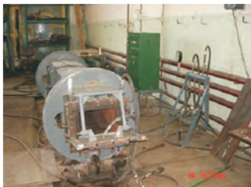
Рисунок 1 – Опытно-промышленный образец установки для модификации древесины с загрузочным объемом 0,2 м 3
