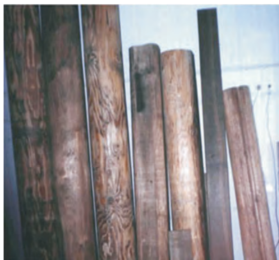
Рисунок 2 – Образцы древесины, обработанной в УМД: бревна сосны, березы, ели, брус дуба; справа – бревна с выпрессованными пазами под сборку
