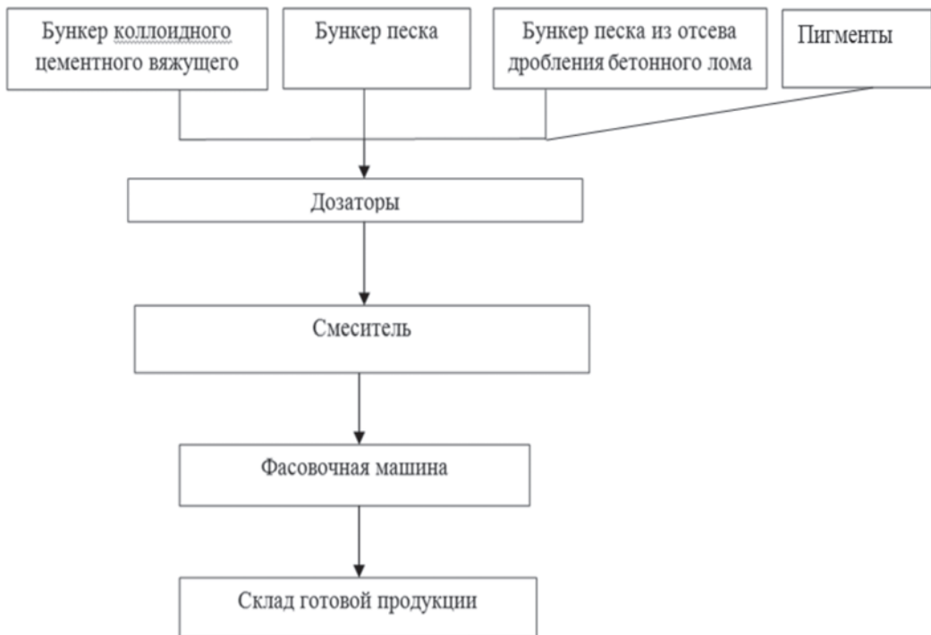
Технологическая схема получения сухих коллоидно-цементных смесей
