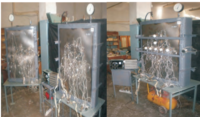
Рисунок 1 – Общий вид модели фрагмента стенки резервуара с вмятинами
