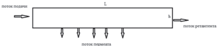
Рисунок 1 – Геометрия модели для базовой 2D-модели ламинарного потока через канал пористой мембраны
