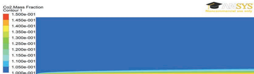
Рисунок 3 – Изменение массовой доли \text{CO}_2 в 2D мембранном канале, включая концентрационный поляризационный пограничный слой: а) для \text{Re} = 200 , б) для \text{Re} = 600
