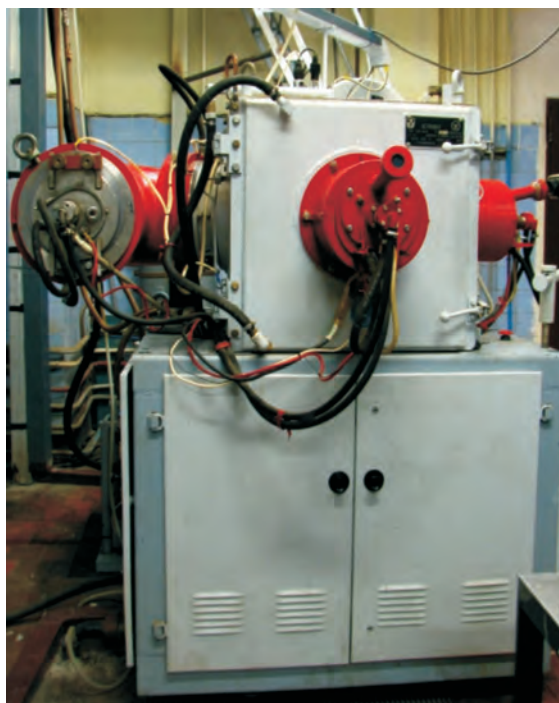
Рисунок 1 – Установка для нанесения покрытий ННВ-6.6
