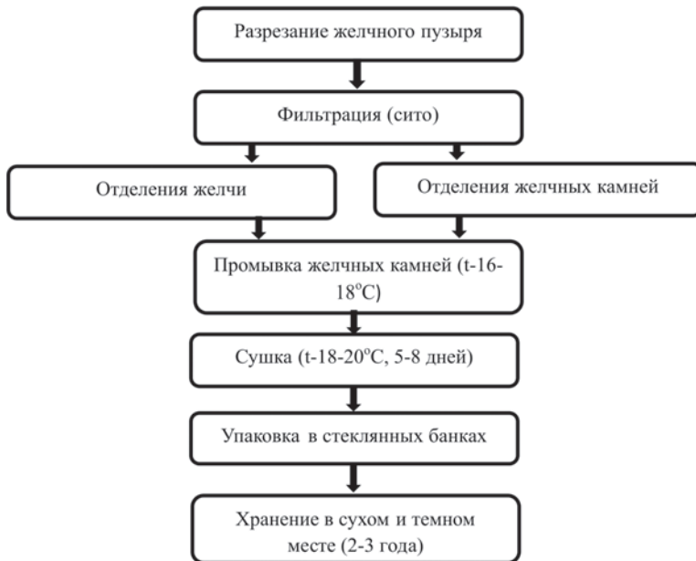
Рисунок 3 – Технологическая схема отделения желчных камней от желчи
