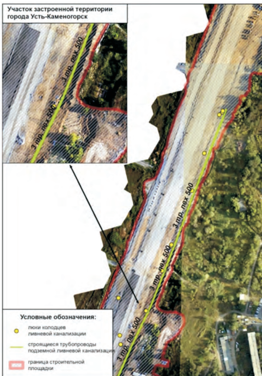
Рисунок 1 – Участок застроенной территории города Усть-Каменогорск со строящейся подземной ливневой канализацией
