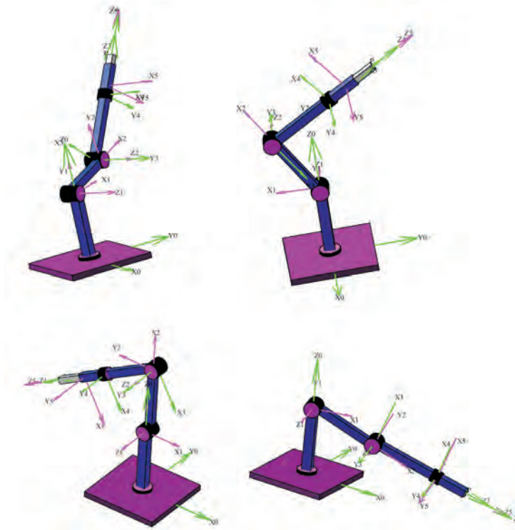
Рисунок 4 – Несколько положений смоделированного RRRRT манипулятора в движениях.
