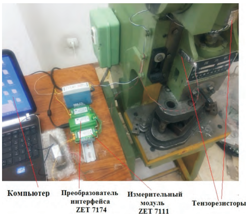
Рисунок 5 – Стенд для экспериментального исследования кривошипного пресса
