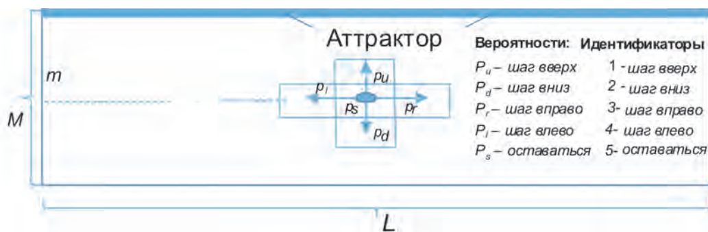
Рисунок 1 – Иллюстрация к описанию алгоритма случайного блуждания при наличии аттрактора на верхней стенке.
