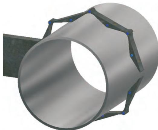
Рисунок 7 – Плоская схема и 3D-модель трехфалангового схвата
