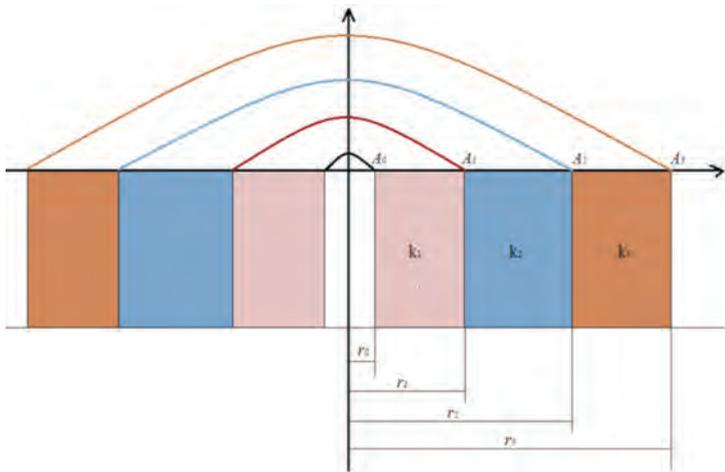
Рисунок 1 – Расчётная схема теплопроводности
