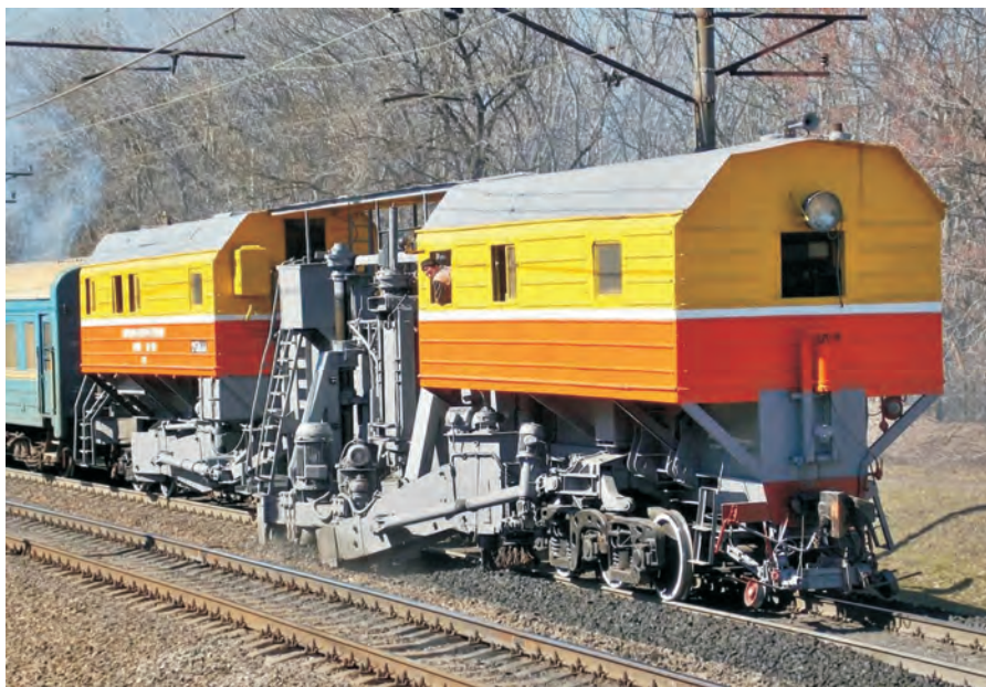
Сурет 1 – ВПО-3-3000 түзету-қағу-өңдеу машинасы
