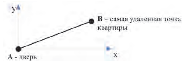
Рисунок 5 – Схема пути эвакуации из комнаты A(x_A, y_A) , B(x_B, y_B)
