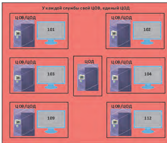
Рисунок 2 – Децентрализованная схема ЦОВ
