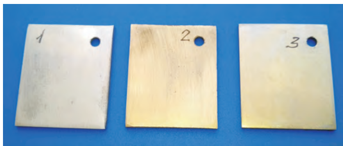
Рисунок 2 – Образцы с покрытием: 1 - подложка титана, 2 - подложка титана-нитрид титана, 3 - подложка титана-оксид титана
