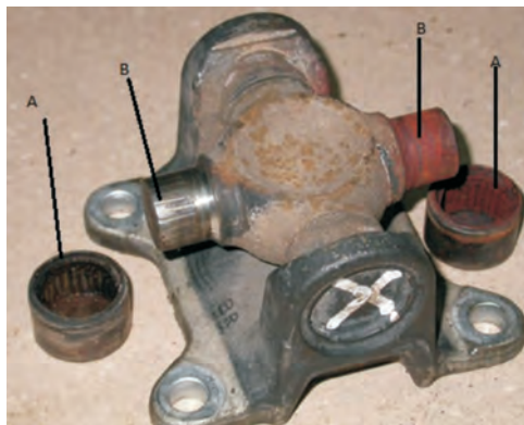
Рисунок 1 – Внешний вид изношенных деталей («ложное бринеллирование») подшипникового узла крестовины: а) – обойма подшипника, б) – цапфа крестовины
