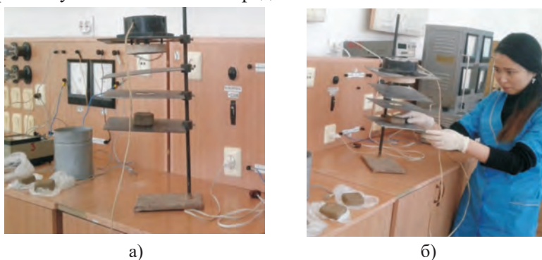
Рисунок 1 – Установка по определению коэффициента чувствительности к сушке а) общий вид установки, б) момент проведения экспериментальных работ.
