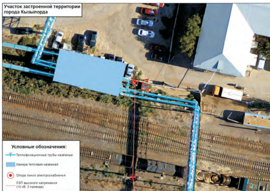
Рисунок 6 – Участок застроенной территории города Кызылорда и нарушение нормативного расстояния ЛЭП высокого напряжения от надземной теплотрассы
