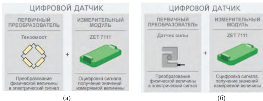
Рисунок 2 – Цифровые датчики с измерительным модулем ZET 7111: а) с использованием тензомостов; б) с использованием тензодатчика
