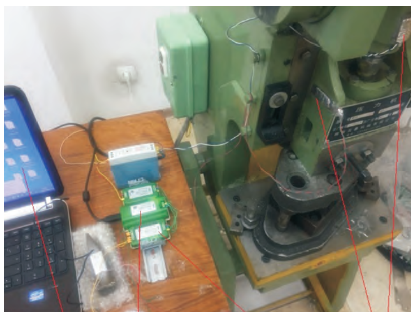
Компьютер Преобразователь интерфейса ZET 7174 Измерительный модуль ZET 7111 Тензорезисторы
